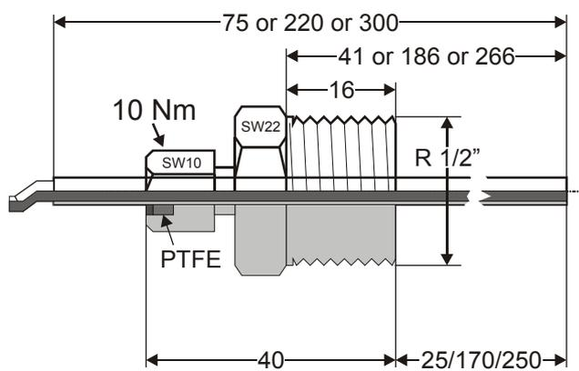
Рис.1 Размеры (мм)
